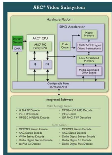
Figure 2 – ARC<sup>®</sup> Video 401 Subsystem
